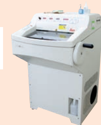
「クライオスタット」。凍結されたブロックをスライスして標本に
